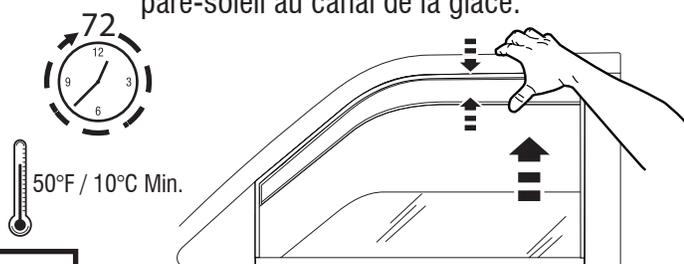
**Ensemble 4 pièces** Installer les visières arrière en utilisant la même méthode de préparation et d'installation que pour la visière avant. Noter que le rebord arrière se fixe à l'extérieur du montant de glace.
