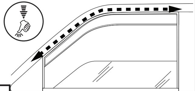
Continúe aplicando presión para asegurarse de que el visor encaje correctamente dentro del canal de la ventana ya que la ventana se cierra lentamente. Suba la ventana durante 72 horas para asegurar el visor en el canal de la ventana.
