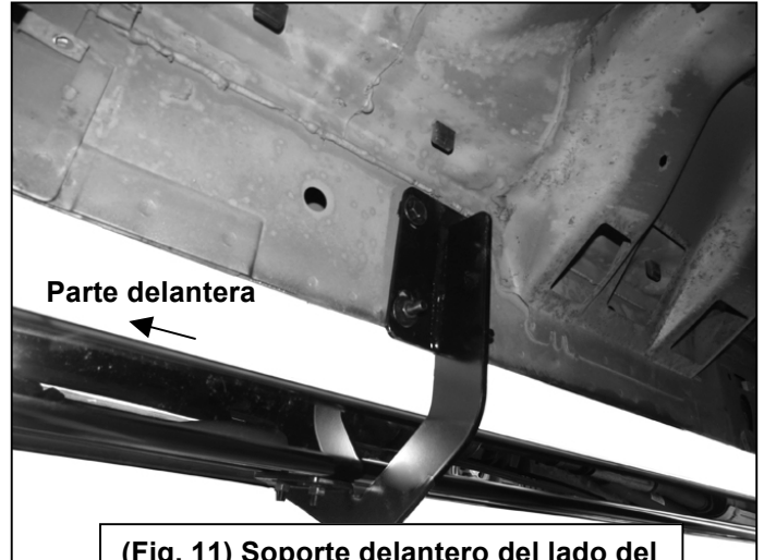
(Fig. 11) Soporte delantero del lado del pasajero sujetado al estribo lateral
