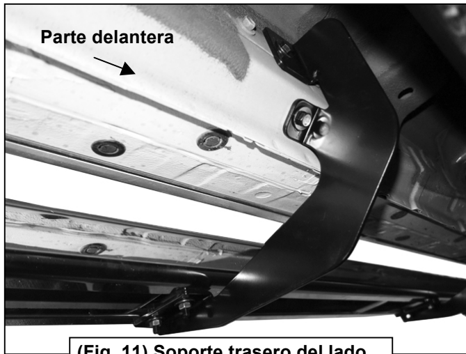
(Fig. 11) Soporte trasero del lado del conductor sujetado al estribo lateral
