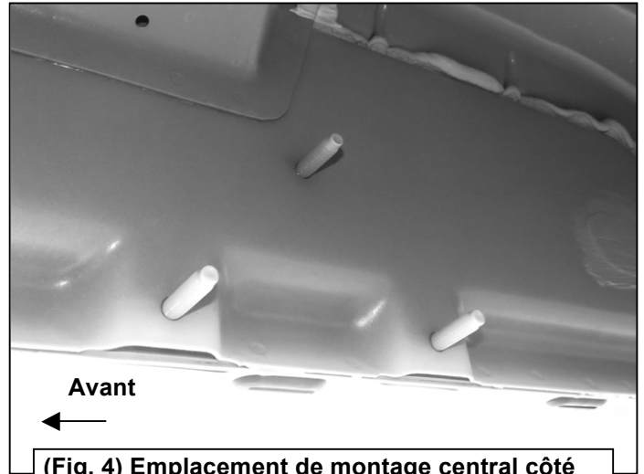
(Fig. 4) Emplacement de montage central côté passager
