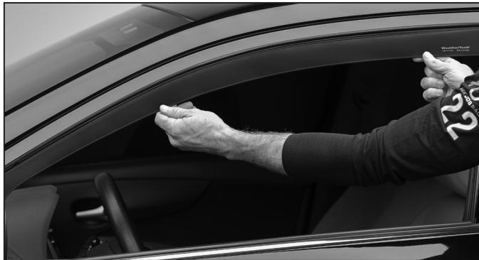
**6** Carefully pull outward on the deflector. *Tire cuidadosamente el deflector hacia afuera.*
