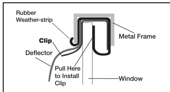
**2** View of proper installation. Vista de la instalación correcta.
