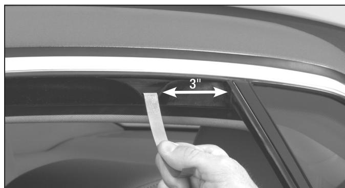
**1** Make sure that the window is clean and dry. Then, pull down the weather-strip with the provided tool approximately 3" from the rear edge. Asegúrese de que la ventanilla esté limpia y seca. Luego tire del burlete hacia abajo con la herramienta provista, aproximadamente 3 pulgadas del borde trasero.
