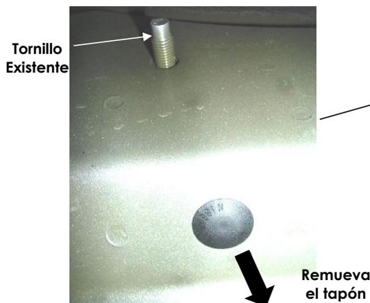
5. Coloque el bracket y fije en la rosca existente con ( 1 ) tornillo cab. hex. M8, utilice rondanas planas y de presión 5/16". Asegure el bracket al tornillo existente con rondanas plana y de presión 5/16" y tuerca hex. M8. No apriete aún. Foto3. Repita el mismo procedimiento para cada bracket.
