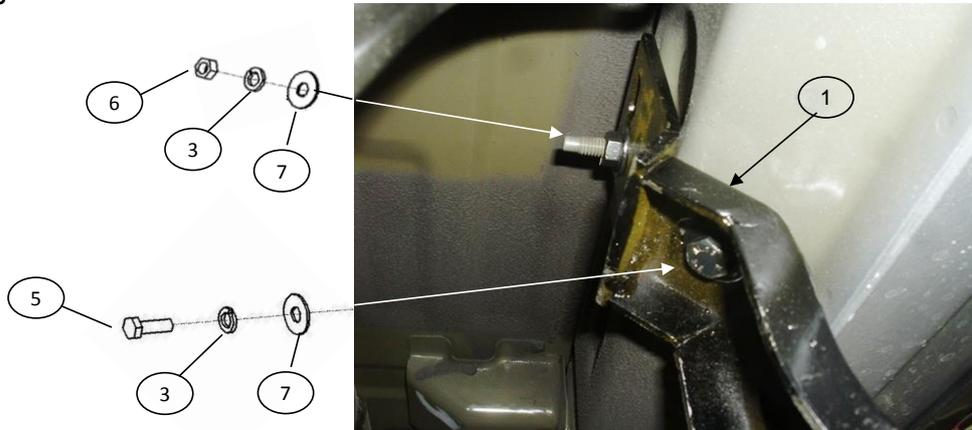
6. Para instalar el Estribo ovalado widesider bar 4", colóquelo sobre los brackets y fije con: tornillo hex 5/16"x1", rondanas planas 3/8" y de presión 5/16". VER FOTO 4 Y ILUSTRACION 1. Repita para el lado contrario. No apriete aún.
