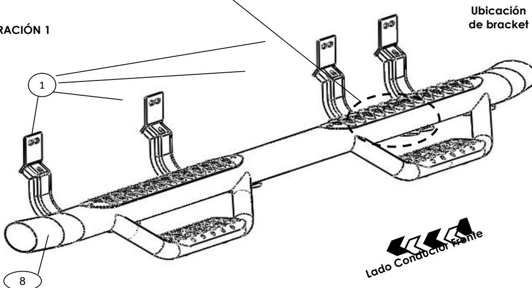
7. Haga cualquier ajuste final a la alineación y apriete toda la tornillería, empezando por los brackets y después el Estribo ovalado widesider bar 4".
