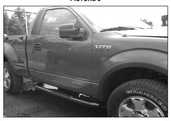
**INSTALLED SIDE BAR.**
